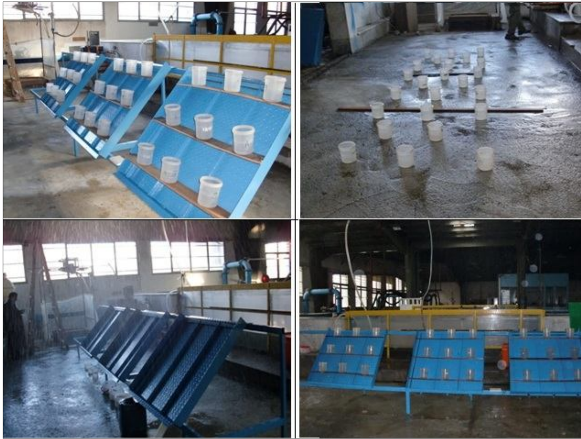
شکل 4- اندازه‌گیری و تنظیم شدت و یکنواختی بارش روی زمین و فلوم شیب‌دار
