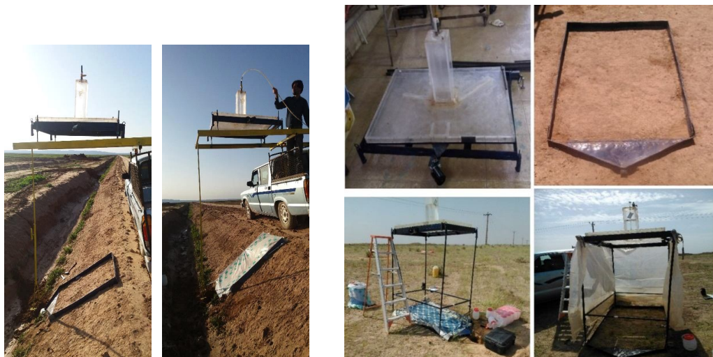
شکل 5- سامانه شبیه‌ساز باران صحرایی و متعلقات آن
