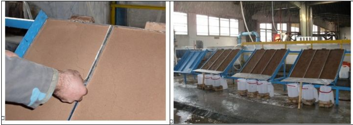
شکل 3- نمایی از فوم، تشک‌های فلزی (به طول 100، عرض 35 و ارتفاع 6 سانتیمتر) و دستگاه شبیه‌ساز باران
