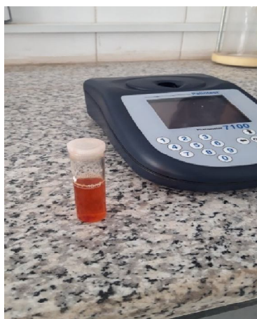
شکل 4- دستگاه مورد استفاده برای تعیین نیترات نمونه‌های آب (پالین تست 7100)
